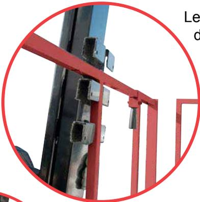
Le dispositif peut être ajusté pour tenir des panneaux longs jusqu'à 3,65 m et peut soulever jusqu'à 40 kg. La fixation peut être ajustée à trois positions différentes même pour les hommes les plus grands.
