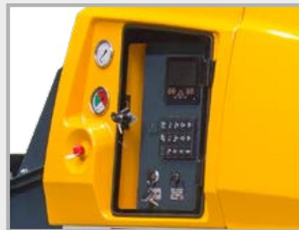
Pavé de commande central avec clavier intuitif selon le principe « Suivre l'éclairage bleu » – commande simple et fiable, parfaitement protégée grâce à la robuste porte en plexiglas.
